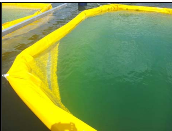
Bild 3. Inneslutningens vatten färgades grönt efterfällning.
