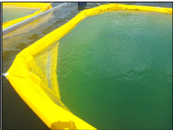
Bild 3. Inneslutningens vatten färgades grönt efter fällning.
