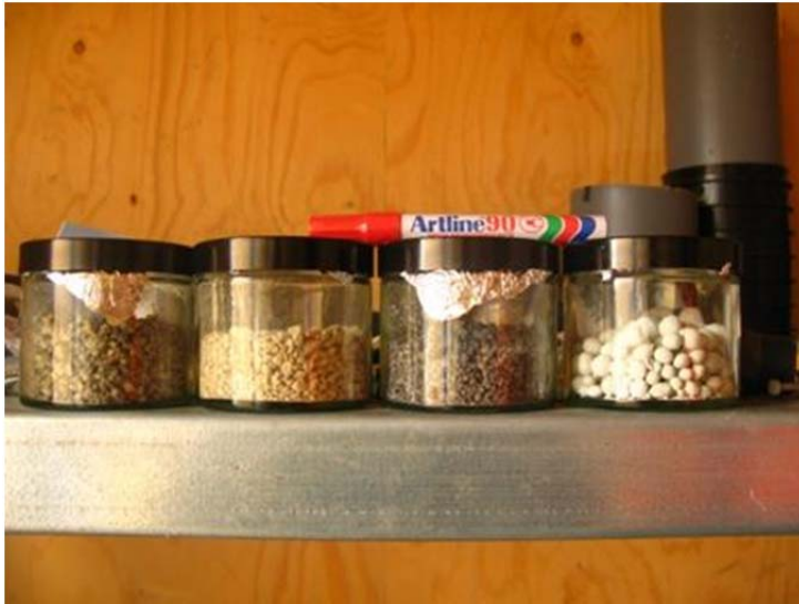
Figur 5: De olika testmaterialen, från vänster till höger: Hyttsand, Polonite, Filtralite-P, och Filtra-P.
