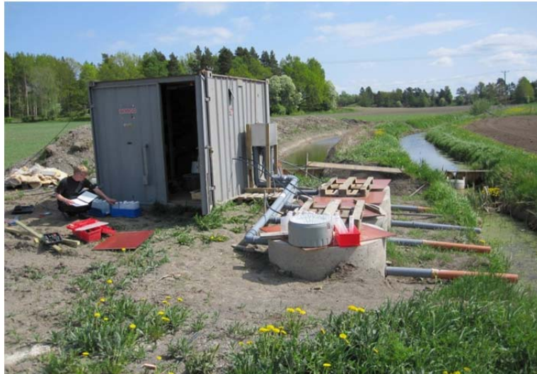
Figur 11: Anläggningen utanför Rimbo. På alla tre anläggningarna ligger filterbrunnarna uppe på diketets sida och vattnet pumpas upp till dem, för att få kontroll på hur mycket vatten som rinner igenom. Vid operativ tillämpning kommer brunnarna att ligga nere i diket, och vattnet kommer att rinna igenom med självfall.
